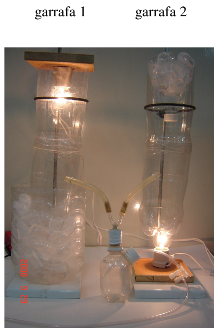
Figura 1- Montagem do simulador de inversão térmica.
